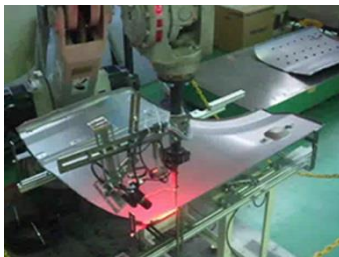
ヘムシール検査装置（ドア外板内側に塗られるヘムシールを画像処理にて検査する装置）
