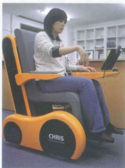
CHRIS. サイバネティック・ヒューマン・ロボット・インターフェース・システムの略。車椅子のボディはアルミ。デザインは筑波大学の院生、梅津大輔氏が担当。CHRIS. CHRIS stands for Cybernetic Human-Robot Interface System. The wheelchair body is made of aluminum. Daisuke Umetsu, a graduate student at the University of Tsukuba was in charge of its design.
