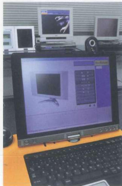
CHRISでテレビを操作するためのメニュー画面。家の中の赤外線リモコンを集めて登録すれば他の家電製品も操作できる。FOMAを使ったテレビ電話機能も開発した。 CHRIS's menu for operating the television. Air-conditioners and lights can also be controlled from CHRIS if it records their infrared remote control codes.
