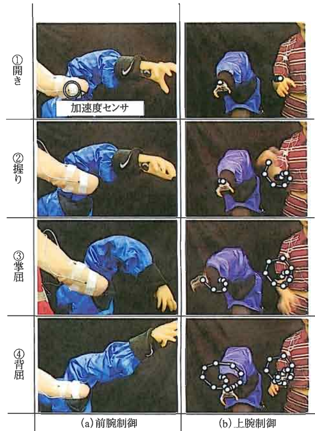
図5 マニピュレータの制御風景 (MMG 制御方式) 加速度センサを用いることで, MMG 信号と上肢運動の加速度を同時に計測してマニピュレータの制御が可能である。
