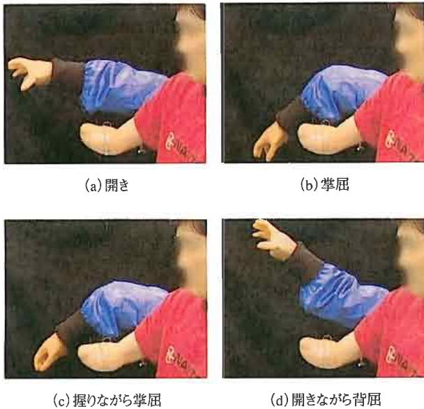
図4 複合動作の制御風景 (EMG 制御方式) 筋シナジーの概念を用いた複合動作の表現法により, “開き” などの単一動作に加えて “開きながら背屈” のような複合動作を実現できる。
